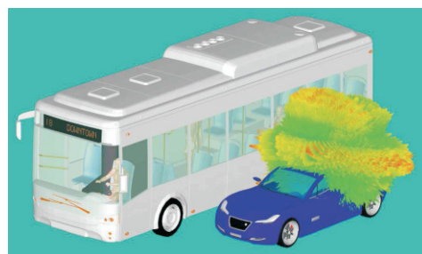
装载性能：轿车上的V2V天线被公交车遮挡后的辐射方向图
