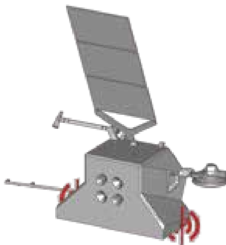
飞船天线布置：BepiColombo水星行星轨道飞行器仿真模型，低增益天线用场源（红色）表示
