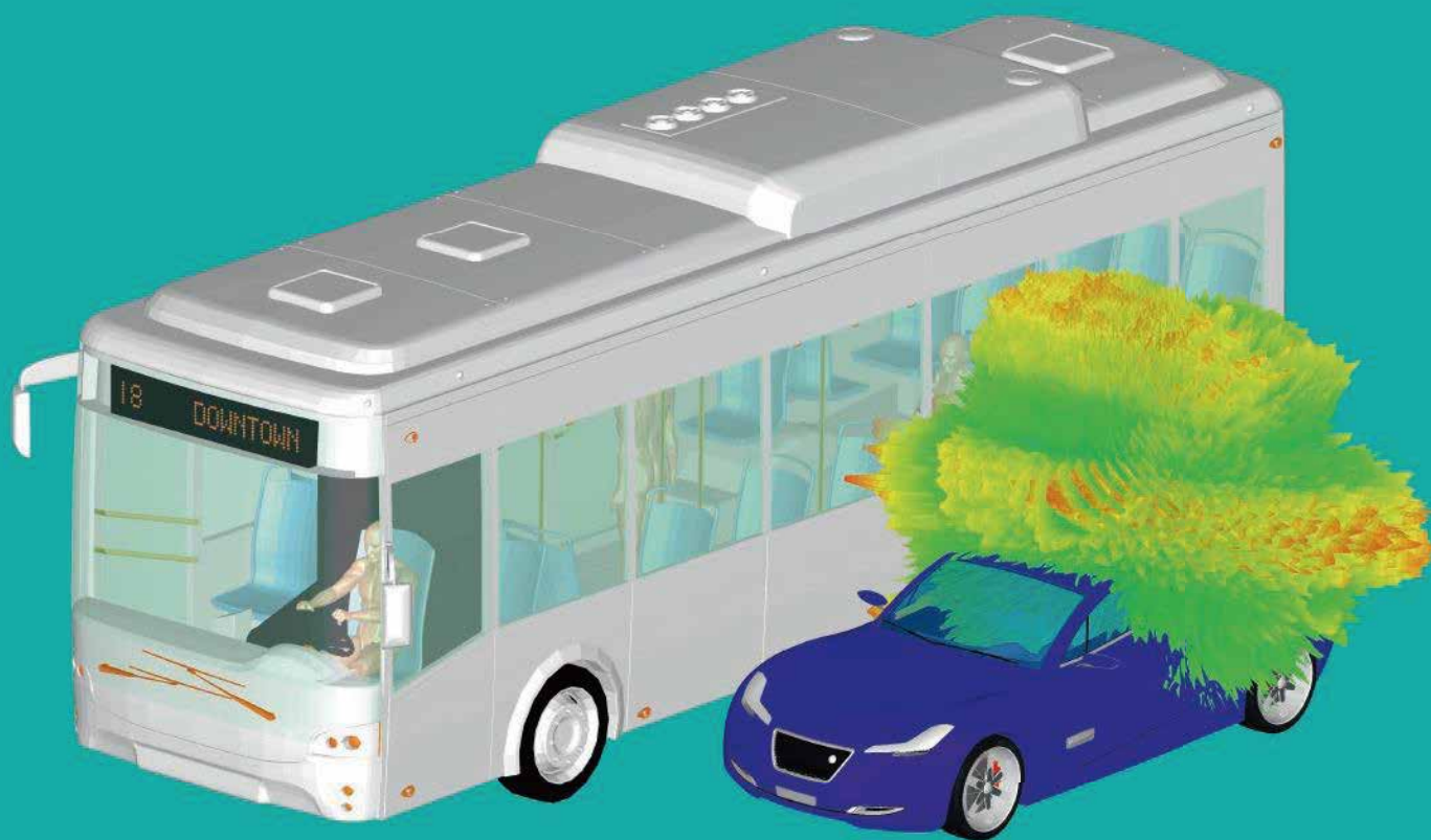
装载性能：轿车上的V2V天线被公交车遮挡后的辐射方向图。
