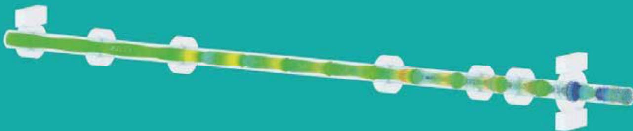
速调管中的粒子轨迹：PIC求解器仿真的1.24米速调管。产生RF信号的粒子束清晰可见。
