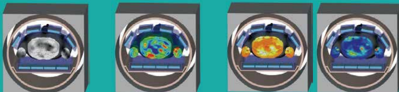
MRI : 7 T MRI的可调阵列和人体模型，从左至右依次显示B1+场分布、点SAR、10分钟后温度和热剂量(CEM43°C)。
